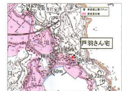
■唯出地区の浸水状況
